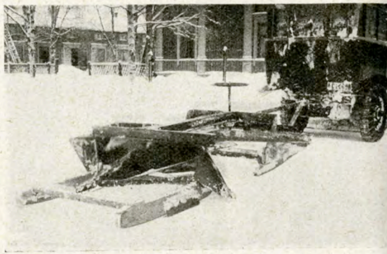
Fig. 13. Redskap för borthyvlning av spår.
